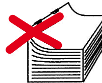
Papier zu dünn - Klammerung trägt auf
